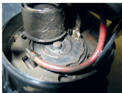
Agresywny chemicznie kondensat spalin w silniku napędzającym pompę powietrza wtórnego
